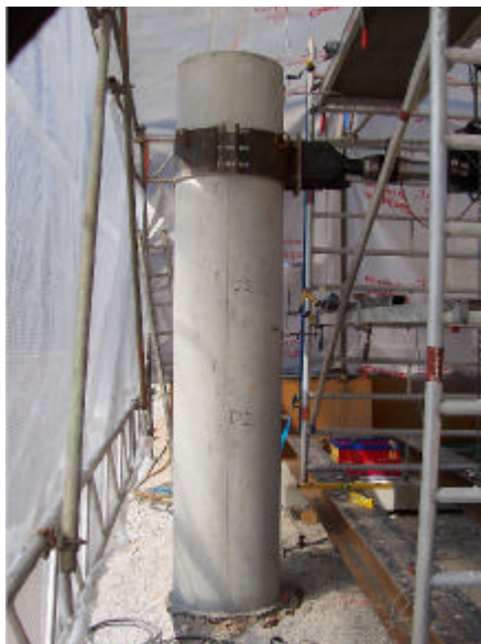
Bild 2: Stahlkonstruktion und Lasteinleitung in den Pfahl
