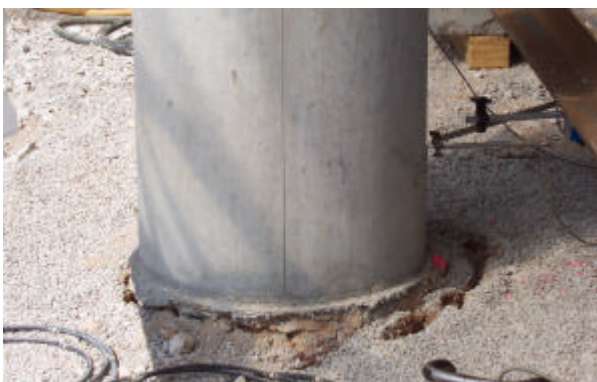
Bild 3: Rissbildungen nach zyklischer Belastung
