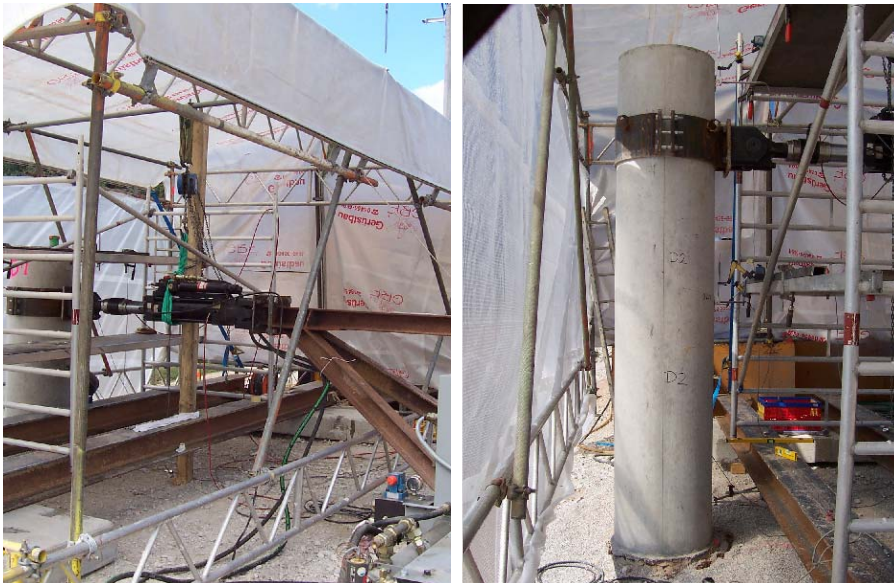
Bild 5: Stahlkonstruktion und Lasteinleitung in den Pfahl
